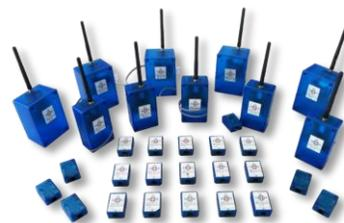
**X-WISE:** Piattaforma HW per acquisizione e trasmissione dati - Internet of Things (IoT).
