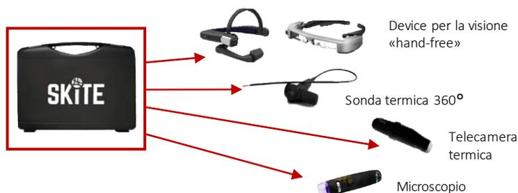
**SKITE™** è un sistema evoluto di **manutenzione da remoto**, che cattura immagini dal campo grazie a sensori con riconoscimento visivo, integrabili con dispositivi di visione Hands-Free per l'operatore a distanza utile durante le attività di assistenza tecnica
